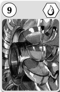
Die Pelton-Turbine nutzt die Bewegungsenergie des fallenden Wassers: Aus einer oder mehreren Düsen strömt Wasser, trifft auf die becherförmig ausgeführten Schaufeln und treibt das Laufrad an. Die Pelton-Turbine wird in Wasserkraftwerken mit sehr großen Fallhöhen aber nicht allzu großen Wasserströmen eingesetzt, oft auch im Zusammenhang mit einem Stausee.
