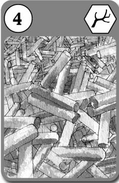
Pellets sind etwa so gross wie eine längliche Pille. Sie bestehen aus unbehandelten Holzresten (Waldholzabfall, Hobelspäne, Sägespäne), die zermahlen, verdichtet und zu kleinen Röllchen gepresst werden. Pellets werden in vollautomatischen Heizanlagen als Brennstoff eingesetzt. Gegenüber den → Hackschnitzeln haben sie den Vorteil, eine gleichmässige Form und Grösse zu haben, wodurch die Feuerungsanlagen störungsfreier arbeiten.
